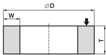
Кольцевой шлифовальный круг 2 - D \times T - W...
