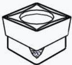
Проверьте состояние крепления инструмента (место под пластину, подкладку, рычаг, винт) и проверьте хорошо ли пластина сидит и зажимается.
