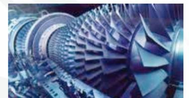
Thermische Welle für eine Dampfturbine. Mitteldruckläufer.
