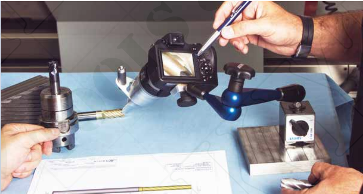
Verschleißerkennung und Auswertung im Labor. Wear detection and evaluation in the laboratory.
