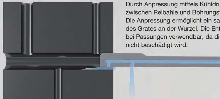
Durch Anpressung mittels Kühldruck wird der Spalt zwischen Reibahle und Bohrungswand geschlossen. Die Anpressung ermöglicht ein sauberes Abschneiden des Grates an der Wurzel. Die Entgratreibahle ist auch bei Passungen verwendbar, da die Bohrungswand nicht beschädigt wird.
