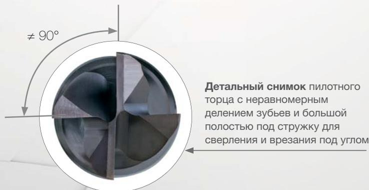
**Детальный снимок** пилотного торца с неравномерным делением зубьев и большой полостью под стружку для сверления и врезания под углом
