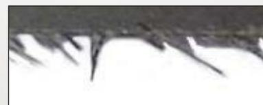
Типичная деламация на фрезерованной кромке детали CFK
