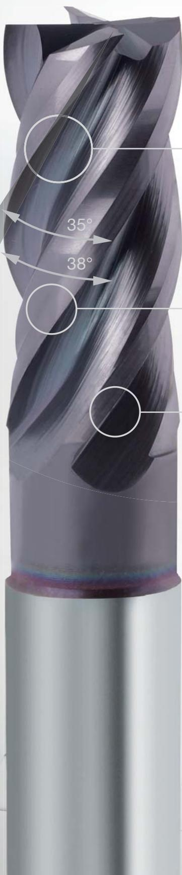
**Отличная плавность** обработки благодаря неравномерным углам спирали 35°/38°
